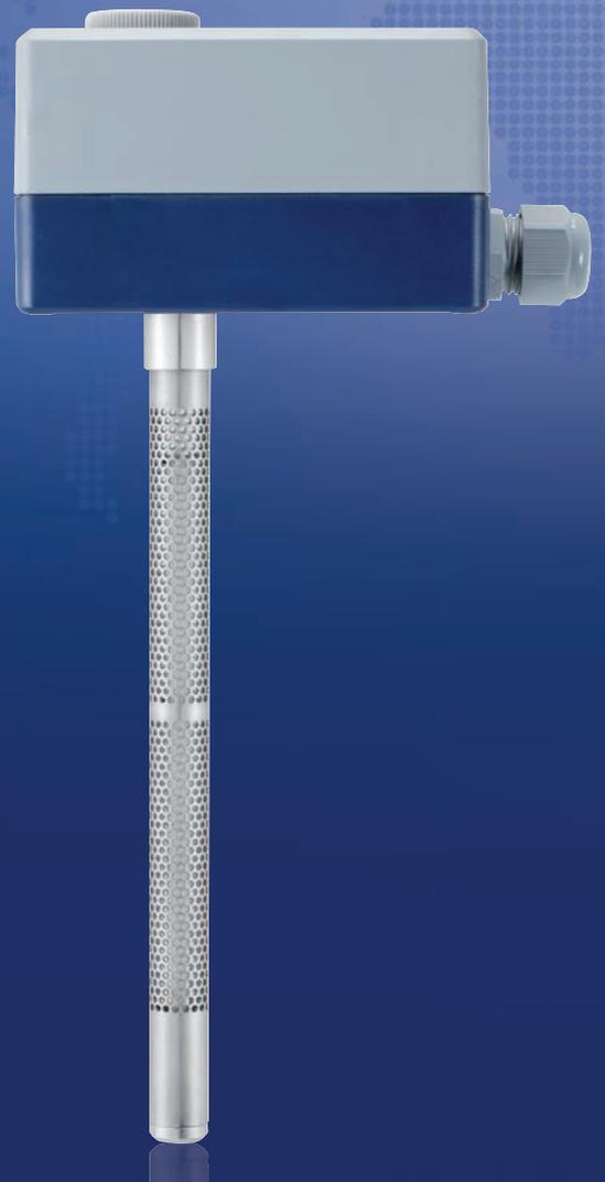
Особые свойства гигроскопичных полимерных волокон используются в гигрометрических измерительных преобразователях для определения относительной влажности воздуха. Благодаря особой обработке, измерительный элемент из волокна приобретает способность абсорбировать влагу. Изменение длины чувствительного элемента регистрируется прецизионной механикой и преобразуется в электрический сигнал, пропорциональный относительной влажности окружающего воздуха.
