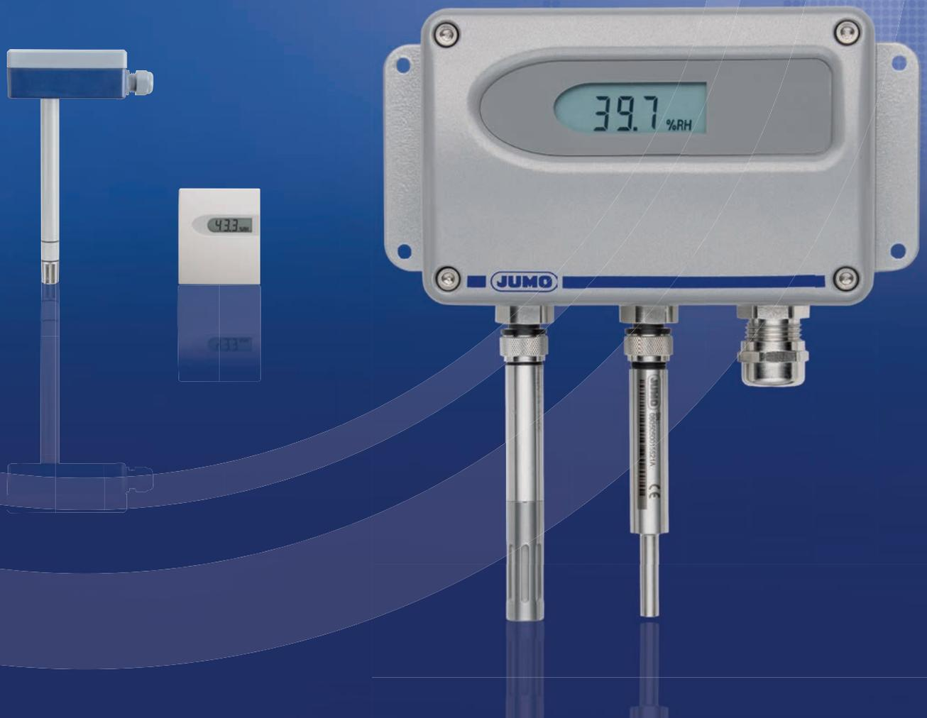
Применение емкостных сенсоров в приборах для измерения относительной влажности открыло новые возможности как для промышленных применений, так и в технике кондиционирования воздуха. Отличительными особенностями этих сенсоров являются малые размеры и малое время отклика. Кроме того, они более устойчивы к воздействию атмосферных загрязнений, пыли и конденсата.
